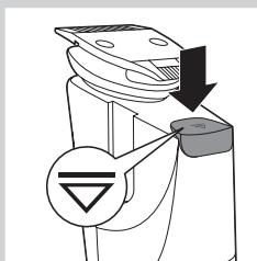
**Opomba:** Če prirezujete z laserskim vodilom, ga premaknite na položaj za izklop, preden obrnete prirezovalno glavo. Če prirezovalno glavo poskušate obrniti, ko je lasersko vodilo še zunaj, vodilo lahko poškodujete.
