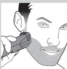
Уредът се доставя заедно с два гребена: за обикновено и за фино подстригване. Тези гребени държат подстригващата глава на определено разстояние от кожата ви. Това разстояние определя оставащата дължина на окосмяването и може да се зададе чрез завъртане на регулиращото колелце.
