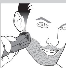
Пристрій постачається із двома гребінцями: стандартним гребінцем і точним гребінцем. Ці гребінці тримають головку тримера на певній відстані від шкіри. Ця відстань визначає довжину волосся після підстригання і налаштовується повертанням коліщатка регулювання.
