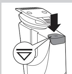
**Примітка:** У разі підстригання з використанням лазерного маркера перед повертанням головки тримера його потрібно встановити в положення вимкнення. Якщо повернути головку тримера, коли лазерний маркер все ще піднято, його можна пошкодити.
