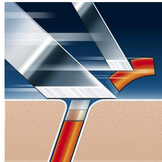
Sistema de lâminas duplas do barbeador Philips: a primeira levanta o pelo e a segunda corta, proporcionando um barbear rente e confortável.
