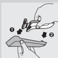
**4** Prvo stavite vrh aparata za brijanje na Power Pod (1), a onda stavite donji deo na Power Pod (2).
