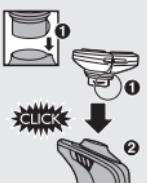
**2** Вставьте выступ нового бритвенного блока в паз на верхней части бритвы (1). Затем надавите на бритвенный блок (2), чтобы присоединить его к бритве (должен прозвучать щелчок).
