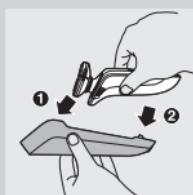
**4** Introduceți mai întâi partea superioară a aparatului de ras în Power Pod (1) și apoi apăsați partea inferioară în Power Pod (2).
