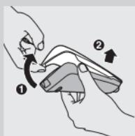
**3** Trageți din partea superioară a capacului (1) și scoateți-l (2).
