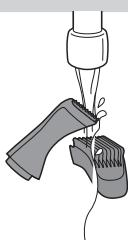
**5** 以溫水沖洗精準修整刀頭和精準修整梳。
