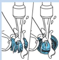
*Σημείωση:* Μην καθαρίζετε πάνω από έναν κόφτη και οδηγό τη φορά, καθώς αποτελούν σετ μεταξύ τους. Σε περίπτωση που τοποθετήσετε κάποιον κόφτη σε λάθος οδηγό ξυρίσματος, ενδέχεται να μεσολαβήσει διάστημα αρκετών εβδομάδων μέχρι να αποκατασταθεί η άριστη απόδοση στο ξύρισμα.
