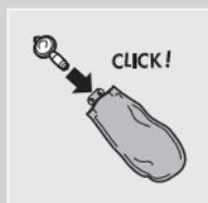
**1** Ked' otvoríte nové balenie náplní, vyberte pumpičku z obalu a zasuňte ju do novej náplne tak, aby s cvaknutím úplne zapadla.
