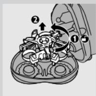
**1** 打开剃须刀头部件，逆时针转动锁 (1)，取下固定架 (2)。
