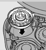
**4** 取下剃须刀头，在剃须刀头部件上装上新刀头。将固定架装回剃须刀头部件，顺时针转动并锁住。
