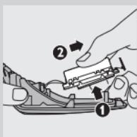
**8** Træk ledningerne ud af motorenheten, og fjern batteriet.
