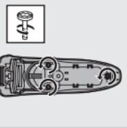
**7** Skruva loss de tre skruvarna på insidan av rakapparaten och ta bort höljet.
