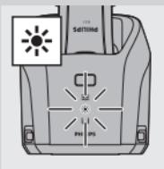
*Hinweis: Sollten Sie während des Reinigungsvorgangs den Ein-/Ausschalter am JetClean System drücken, wird das Reinigungsprogramm abgebrochen und zurückgesetzt. In diesem Fall hört die Reinigungs- oder Trocknungsanzeige auf zu blinken und die Halterung geht zurück in die Ausgangsposition.*
