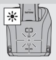
*Merk: Hvis du trykker på av/på-knappen på Jet Clean-systemet under rengjøringsprogrammet, avbrytes og nullstilles programmet. I så fall slutter rengjørings- eller tørkesymbolet å blinke, og holderen går tilbake til utgangsposisjonen.*
