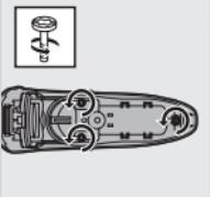
**7** Skru opp de tre skruene på innsiden av barbermaskinen og fjern baksidedekselet.
