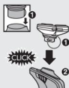
**2** Stecken Sie die Führung der neuen Schereinheit in den Schlitz oben am Rasierer (1). Drücken Sie die Schereinheit dann nach unten (2), so dass sie mit einem "Klick" auf dem Rasierer einrastet.
