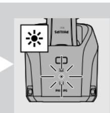
توجه: اگر دکمه روشن/خاموش در سیستم جت کلین را در خلا برنامه تمیز کردن فشار دهید، برنامه متوقف شده و بازنشانی می گردد. در این حالت، چشمک زدن چراغ تمیز کردن یا خشک کردن متوقف شده و نگهدارنده به وضعیت شروع باز می گردد.
