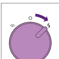
Za funkciju miješanja postoji mjerač za 30 sekundi kao zaštita od pregrijavanja. Ako nakon 30 sekundi niste završili s miješanjem, aparat će se isključiti i kao obavijest začut će se dva zvučna signala. Nakon što ste pustili da se 30 sekundi ohladi, aparat ispušta zvučni signal i ponovno možete početi s miješanjem.
