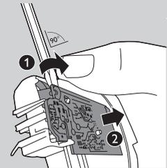
**3** Tegye a csavarhúzót a nyomtatott áramköri lap nyílással jelzett nyílásába (1). Nyomja a csavarhúzóval, amíg a nyomtatott áramköri lap részei letörnek (2).
