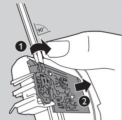
**3** Пъхнете отвертката в малкия прорез на печатната платка, обозначен със стрелка (1). Натиснете отвертката надолу, докато част от печатната платка се отчупи (2).
