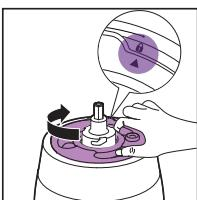
→ Kada je poklopac rezervoara za vodu pravilno pričvršćen na mesto, simbol ▲ na poklopcu se poravnava sa simbolom 🔐 na rezervoaru za vodu.
