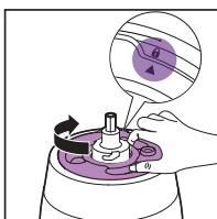
→ Kada je poklopac rezervoara za vodu pravilno pričvršćen na mesto, simbol ▲ na poklopcu će biti poravnat sa simbolom 🔐 na rezervoaru za vodu.
