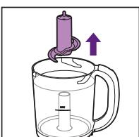
**6** Temeljno očistite jedinicu sa sečivima pod mlazom vode neposredno po završetku upotrebe. Obavezno isperite i unutrašnjost cevi jedinice sa sečivima.
