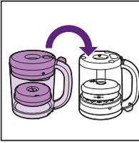
**7** Alinee el conector de la tapa de la jarra con el área de bloqueo del depósito de agua y, a continuación, coloque la jarra en la unidad principal con la tapa de la jarra en la parte inferior. Presione la jarra hacia abajo para que quede encajada en la unidad principal y asegúrese de que el asa queda en el lado derecho.
