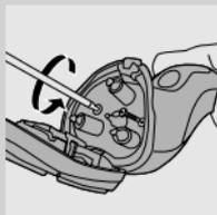
**2** La barbermaskinen stå på til den stopper, og skru ut de to skruene på baksiden av barbermaskinen.
