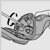
**2** Låt rakapparaten gå tills den stannar och skruva ur de två skruvarna på rakapparats baksida.
