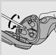
**2** Αφήστε την ξυριστική μηχανή να λειτουργήσει μέχρι να σταματήσει και ξεβιδώστε τις δύο βίδες στο πίσω μέρος της ξυριστικής μηχανής.
