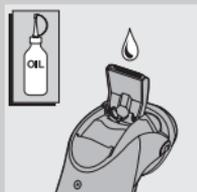
**3** Smeer elke zes maanden de tanden van de tondeuse met een druppeltje naaimachineolie.
