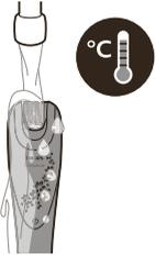
3 Enxágue o aparelho com água a uma temperatura máxima de 40 °C.
