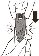
2 Coloque el aparato dentro del cargador.
