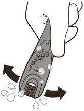
4 Chacoalhe o aparelho para retirar a água em excesso e deixe o aparelho secar.
