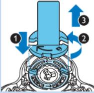
3 Τοποθετήστε το στήριγμα του δακτυλίου συγκράτησης στο δακτύλιο συγκράτησης (1), γυρίστε το αριστερόστροφα (2) και βγάλτε το από την ξυριστική κεφαλή (3). Αφαιρέστε το δακτύλιο συγκράτησης από το στήριγμα και επαναλάβετε αυτήν τη διαδικασία και για τους υπόλοιπους δακτύλιους.
