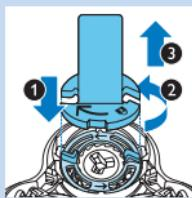
**3** Aseta kiinnitysrenkaan pidike kiinnitysrenkaaseen (1), kierrä sitä vastapäivään (2) ja nostaa se irti ajopäästä (3).
