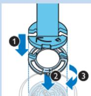
**6** Placer samleringsholderen på samleringen (1), placer den på skærhovedet (2), og drej den med uret (3) for at sætte samleringen på igen. Gentag denne proces for de andre samleringe.
