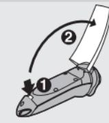
**۳** کارتريج را همراه با پمپ به درون ماشين اصلاح فشار دهيد. کارتريج فقط هنگامی در جاي خود قرار می گيرد که قسمت سفید پمپ بطرف بالا باشد.
