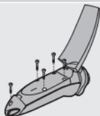
**1** Deje que la afeitadora funcione hasta que se pare. A continuación, afloje los tornillos y abra la afeitadora.
