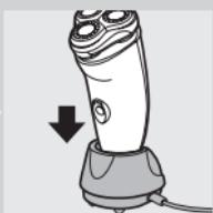
**٣** انزع قابس التيار الكهربائي من مقبس الحائط وانزع قابس الجهاز من ماكينة الحلاقة عندما يكتمل شحن البطارية. وعندئذ يمكنك ترك الجهاز في قاعدة الشحن.
