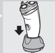
افصل دوماً التيار الكهربائي عن قاعدة الشحن قبل تخزين ماكينة الحلاقة المبللة أو الجافة فيها.
