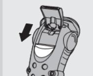
**1** 向下推动滑块，打开修发器。
