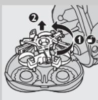
**1** Aprite l'unità di rasatura, ruotate il pulsante di sgancio in senso antiorario (1) e togliete il telaio di supporto (2).
