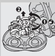
**2** Drücken Sie den Entriegelungsknopf und öffnen Sie die Schereinheit.
