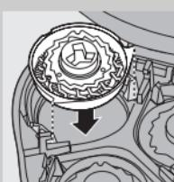
**3** Ruotate il pulsante di sgancio in senso antiorario (1) e togliete il telaio di supporto (2).
