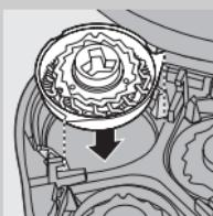
**3** Drehen Sie die Verriegelung gegen den Uhrzeigersinn (1) und entnehmen Sie den Scherkopfhalter (2).
