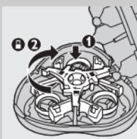
**4** Entnehmen Sie die Scherköpfe und setzen Sie neue Scherköpfe in die Schereinheit. Die Vorsprünge an den Scherköpfen müssen genau in die Aussparungen der Schereinheit passen.
