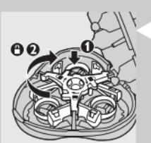
**5** Rimettete il telaio di supporto nell'unità di rasatura (1) e ruotate il pulsante di sgancio in senso orario (2).
