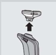
**2** Pasangkan pelat sambung unit pencukur ke dalam slot di bagian atas alat cukur (1). Kemudian tekan unit pencukur ke bawah (2) untuk memasangkannya ke alat cukur ('klik').
