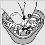
**7** Rimettete le testine nell'unità di rasatura. Rimettete la struttura di supporto nell'unità di rasatura (1) e ruotate la rotella in senso orario (2).
