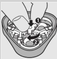
**5** Replacez la molette (1), puis faites-la tourner dans le sens des aiguilles d'une montre (2).
