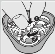
**5** Tespit çerçevesini tıraş ünitesine (1) yerleştirin ve çarkı, saat yönünde (2) çevirin.
