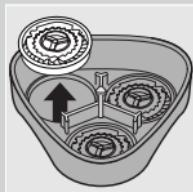
**4** Rimuovete le lame e le relative protezioni e puliteli con lo spazzolino in dotazione.
