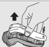
Não volte a ligar a máquina de barbear à corrente depois de a bateria ter sido removida.
