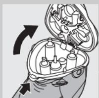
**1** Isključite aparat, izvucite kabel punjača iz zidne utičnice i aparata.
