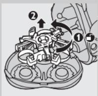
**1** Otvorite jedinicu za brijanje, okrenite bravu u smeru suprotnom od kazaljke na satu (1) i izvadite granični okvir (2).
