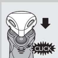
► Nasadte na přístroj ochranný kryt, abyste předešli poškození holicích hlav.
