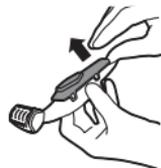
**6** 充電電池を持ち上げて工具でワイヤーを切断し、充電電池を取り出します。
