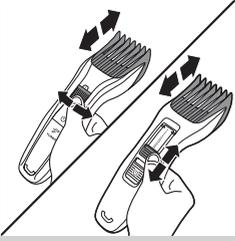
**2** 将长度设定调节器转到所需的长度设定。
