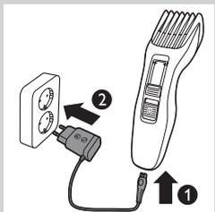
**2** 将产品的插头插入本产品 (1)，然后将适配器插入电源插座 (2)。
