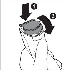
**8** Masukkan cuping unit pemotong ke dalam slot pemandu (1) dan tolak unit pemotong kembali pada perkakas (2).
