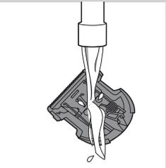
**5** Làm sạch bộ phận cắt bằng bàn chải hoặc rửa dưới vòi nước.
