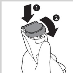
**2** 將新刀組的突耳插入導引槽 (1)，接著將刀組推回產品裝上 (2)。
