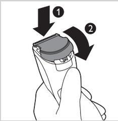
**8** Masukkan cuping unit pemotong ke dalam selot pemandu (1) dan dorong unit pemotong kembali ke dalam alat (2).
