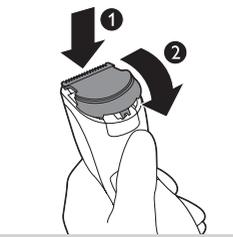
**8** Lắp gờ của bộ phận cắt vào rãnh dẫn (1) và ấn bộ phận cắt vào lại thiết bị (2).
