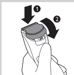
**8** 將刀組的突耳插入導引槽 (1)，接著將刀組推回產品裝上 (2)。
