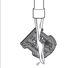
**5** Bersihkan unit pemotong dengan sikat atau bilas di bawah keran.
