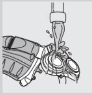
**3** Rengjør skjæreenheten og skjeggkammeret ved å skylle begge deler under rennende, varmt vann en stund.
