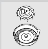
**1** Öffnen Sie die Schereinheit, drehen Sie die Verriegelung gegen den Uhrzeigersinn (1), und entnehmen Sie den Scherkopfhalter (2).
