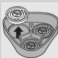
**3** Okrenite kotačić u smjeru obrnutom od smjera kazaljke na satu (1) i izvadite okvir za pričvršćivanje (2).
