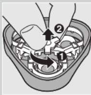
**3** Odkręć blokadę w lewo (1) i wyjmij element zabezpieczający (2).
