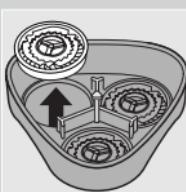
**3** Okrenite točkić u smeru suprotnom od kazaljke na satu (1) i izvadite granični okvir (2).
