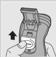
**1** Отворете ножчето за подстригване на бакенбарди чрез избутване на плъзгача надолу.
