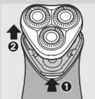
**1** Isključite aparat za brijanje, izvucite kabl za napajanje iz zidne utičnice i izvadite utikač iz aparata.
