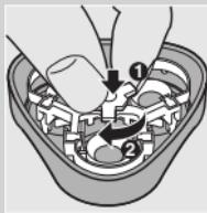
**5** Następnie załącz element zabezpieczający na element golący (1) i obróć blokadę w prawo (2).
