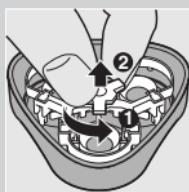
**2** Pritisnite gumb za otpuštanje (1) i izvadite jedinicu za brijanje (2).
