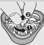
**2** Pritisnite dugme za otpuštanje (1) i skinite jedinicu za brijanje (2).
