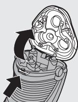
Pentru a garanta performanțe maxime, recomandăm schimbarea capetelor de bărbierire la doi ani. Înlocuiți imediat capetele de bărbierire deteriorate. Înlocuiți capetele de bărbierire doar cu capete de bărbierire Philips HQ8 originale.
