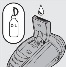
**Sugestie:** Pentru a garanta performanțe optime de tundere, ungeti dinții dispozitivului de tundere cu puțin ulei pentru mașina de cusut o dată la șase luni.
