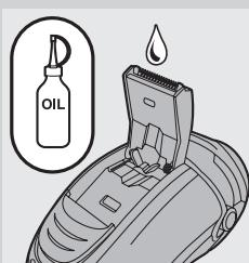
Tip: Abi byl zajištěn optimální výkon při zastřihování, kápněte na zuby zastřihovače jednou za šest měsíců kapku oleje na šicí stroje.
