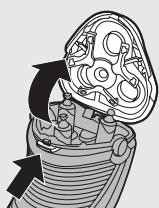
Za najbolje rezultate brijanja, savetujemo vam da glave za brijanje menjate svake dve godine. Odmah zamenite oštećene glave za brijanje. Glave za brijanje zamenite isključivo originalnim HQ8 Philips glavama za brijanje.
