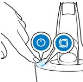
Após a fase de enxágue, a fase de secagem começará automaticamente. Durante essa fase, o símbolo de secagem pisca. Quando a fase de secagem terminar (após cerca de 4 horas), o símbolo de secagem se acenderá continuamente.
