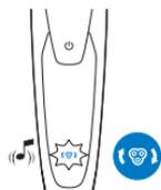
O lembrete de substituição indica que as cabeças de corte precisam ser substituídas. O símbolo da unidade de corte fica continuamente aceso, as setas piscam na cor branca e um sinal sonoro é emitido quando você desliga o barbeador.
