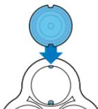
Nota: Certifique-se de que os entalhes em ambos os lados da cabeça de corte se encaixem nas saliências no suporte das cabeças de corte.
