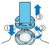
**3** Coloque o suporte do anel de retenção no anel de retenção (1), gire-o no sentido anti-horário (2) e levante-o para fora da cabeça de corte (3).
