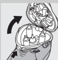
**2** Appuyez sur le bouton de déverrouillage et ôtez l'unité de rasage de l'appareil.
