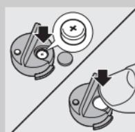
**2** Inserite una batteria nuova e rimettete a posto il cappuccio.
