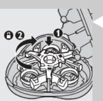
**5** Remontez la plaque de fermeture (1) et tournez le verrou dans le sens des aiguilles d'une montre (2).
