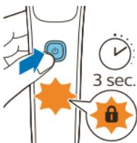
Da biste aktivirali režim putne brave, pritisnite dugme za uključivanje/isključivanje na 3 sekunde. Kad je putna brava aktivirana, njen simbol trepće. Pritisnite dugme za uključivanje/isključivanje na 3 sekunde.
