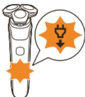
Simbol „otkačiti radi upotrebe” trepće da bi vas podsjetio da trebate isključiti aparat iz zidne utičnice, te izvaditi mali utikač iz aparata prije nego što ga uključite.
