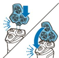
7 Stavite jezičak držača reznih glava u prorez na vrhu nastavka za brijanje i zatvorite nastavak za brijanje.
