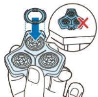
Napomena: Držite držač reznih glava u ruci dok vraćate rezne glave i postavljate pričvrsne prstenove. Ne odlažite držač reznih glava na neku površinu jer tako možete oštetiti rezne glave.
