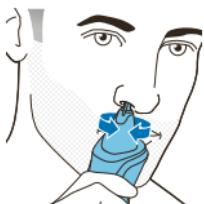
Sasušena nosna sluz može blokirati element za rezanje i sprječavati uključivanje aparata. Ako je element za rezanje blokiran, očistite nastavak.
