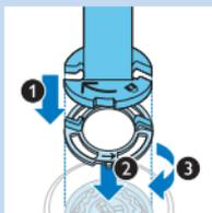
7 將固定環座放置於固定環上 (1)，將其放在電鬚刀刀頭上 (2) 並以順時針方向轉動 (3)，以重新裝回固定環。
