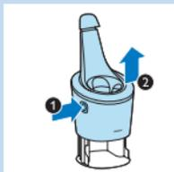
**1** 按下 SmartClean 智慧型清洗系統側面的按鈕 (1)，然後掀開 SmartClean 智慧型清洗系統的頂部 (2)。
