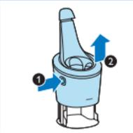
3 กดปุ่มที่ด้านข้างของ SmartClean System (1) และยกด้านบนของ SmartClean System ขึ้น (2)
