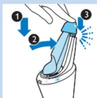
2 วางเครื่องโกนหนวดลงในแท่นวาง (1) เอียงเครื่องโกนไปทางด้านหลัง (2) แล้วกดฝาครอบด้านบนเพื่อเชื่อมต่อเครื่องโกนหนวด (เสียงดัง'คลิก') (3) สัญลักษณ์รูปแบตเตอรี่และปุ่มเปิด/ปิดจะเริ่มกะพริบ ซึ่งแสดงว่าเครื่องโกนหนวดกำลังชาร์จไฟอยู่
