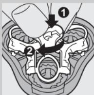
**4** Eemaldage lõikepead ja asendage uutega.
