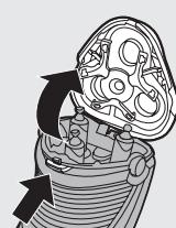
**4** Otočte pojistku směrem doleva (1) a vyjměte přídružný rámeček (2).
