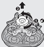
**4** Odkręć blokadę w lewo (1) i wyjmij element zabezpieczający (2).
