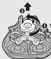
**4** Okrenite bravu u pravcu suprotnom od kazaljke na satu (1) i izvadite granični okvir (2).
