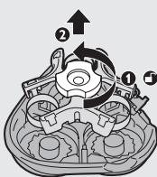
**4** Zavrtite zaklep proti levi (1) in odstranite nosilno ogrodje (2).
