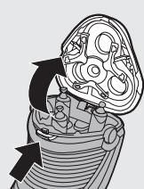
**4** Zámkom otočte proti smeru pohybu hodinových ručičiek (1) a vyberte prítlačný rám (2).
