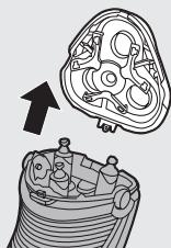
**4** Поверните фиксатор против часовой стрелки (1) и снимите крепёжную рамку (2).
