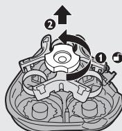
**4** Otočte pojistku směrem doleva (1) a vyjměte přídržný rámeček (2).
