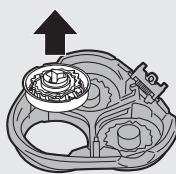
**5** Holicí hlavy čistěte vždy po jedné. Každá holící hlava se skládá z nožového věnce a holící korunky.
