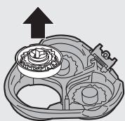
**5** Scoateți și curătați câte un cap de bărbierit pe rând. Fiecare cap de bărbierire este format dintr-un cuțit și o sită de protecție.
