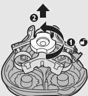
**4** Zámkom otočte proti smeru pohybu hodinových ručičiek (1) a vyberte prítlačný rám (2).
