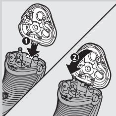
**8** Vložte výstupek holící jednotky do zářezu v horní části holícího strojku (1). Potom holící jednotku (2) zavřete.
