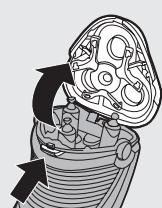
Aby zapewnić jak najlepsze golenie, głowice golące należy wymieniać co dwa lata. Uszkodzone głowice golące należy wymieniać natychmiast. Głowice golące można wymieniać tylko na oryginalne głowice golące HQ8 firmy Philips.
