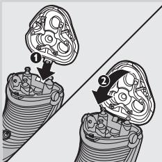
**8** Ubacite ušicu jedinice za brijanje u prorez na vrhu aparata za brijanje (1). Zatim zatvorite jedinicu za brijanje (2).
