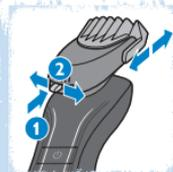
**1** Presione el selector de largo (1) y presione izquierda o derecha (2) para seleccionar la posición deseada de largo de cabello.
