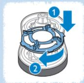
**8** Para volver a colocar el anillo de retención (1) gírelo en dirección opuesta a las flechas del anillo de retención (2).
