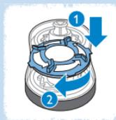
**3** Para volver a colocar el anillo de retención (1) gírelo en dirección opuesta a las flechas en el anillo de retención (2).
