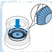
**6** Coloque el peine en el soporte del cabezal de la afeitadora, asegurándose de que las dos aletas encajen perfectamente en los orificios del soporte del cabezal de la afeitadora.
