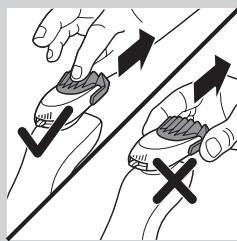
Примечание Снимите гребень. Взявшись за центральную часть, снимите его с насадки-стайлера для бороды. Не беритесь за боковые панели гребня.
