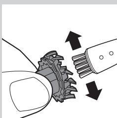
**5** Rezač čistite isporučenom četkicom za čišćenje.
