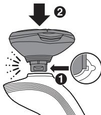
**7** Illessze a borotvaegység nyelvét a borotva tetején lévő résbe (1). Ezután nyomja a borotvaegységet lefelé (2) kattanásig a borotvára helyezéshez.
