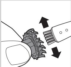
**5** Očistite rezilo s priloženo ščetko za čiščenje.
