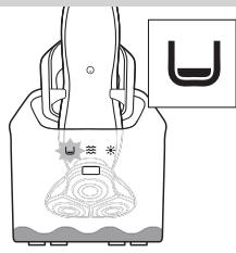
**Napomena:** Ako tijekom programa za čišćenje adapter iskopčate iz zidne utičnice, program će se prekinuti. Držač će ostati u svom trenutnom položaju. Kada adapter ponovo ukopčate u zidnu utičnicu, držač će se pomaknuti na najviši položaj.
