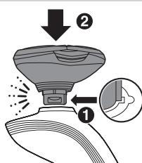
**7** Jezičac jedinice za brijanje umetnите u utor na aparatu za brijanje (1). Zatim jedinicu za brijanje pritisnite prema dolje (2) kako bi se pričvrstila na aparat ("klik").
