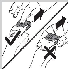
Poznámka: Hrebeňový nástavec uchopte za stred a potiahnutím ho odpojte od nástavca na tvarovanie brady. Hrebeňový nástavec netahajte uchopením za bočné strany.
