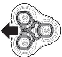
**2** Zeleni nosilni okvir potisnite v smeri puščic na nosilnem okvirju.
