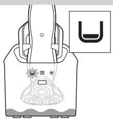
**Забележка:** Ако натиснете бутона за вкл./изкл. на системата Jet Clean докато се изпълнява програмата за почистване, програмата прекъсва. В такъв случай индикаторът за почистване или изсушаване спира да мига и държачът се придвижва в най-горно положение.
