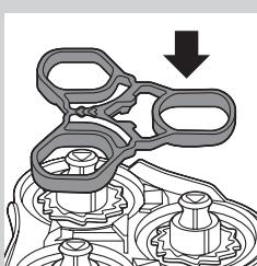
**8** Umístěte zajíšťovací rámeček do držáku holící hlavice.
