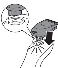
**3** Illessze a szakállformázó tartozék nyelvét a borotva tetején lévő résbe (1). Ezután nyomja a szakállformázó tartozékot lefelé (2) kattanásig a borotvára helyezéshez.
