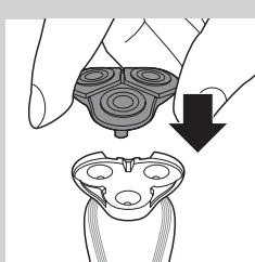
**10** Nosilec brivnih glav namestite na spodnji del brivne enote.
