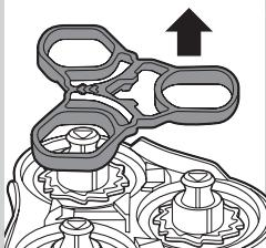
**3** Dvignite nosilni okvir iz nosilca brivnih glav.
