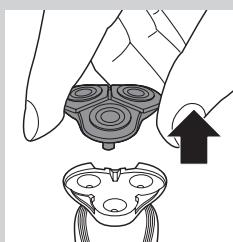
**3** Вийміть тримач бритвеної головки з нижньої частини бритвеного блока та поспоштіть його гарячою водою з-під крана протягом 30 секунд.
