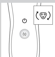
Pentru a garanta performanțe maxime, recomandăm schimbarea suportului capului de radere la fiecare doi ani. Schimbați capul de radere numai cu un **cap de radere original Philips RQ11**.
