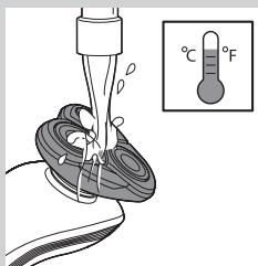
**2** Сполосніть бритвений блок гарячою водою з-під крана.
