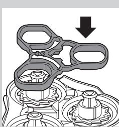
**8** Vratite okvir za pričvršćivanje na držač glave za brijanje.
