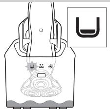
**Примечание** Если во время выполнения программы очистки нажать кнопку включения/выключения системы очистки Jet Clean, программа будет прервана. В этом случае индикатор очистки или сушки перестанет мигать, а держатель переместится в самое высокое положение.
