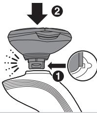
**7 Ubacite ušicu jedinice za brijanje u prorez na vrhu aparata za brijanje (1). Zatim pritisnite jedinicu za brijanje nadole (2) da biste je pričvrstili za aparat („klik“).**
