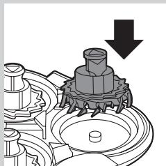
**7** После очистки установите вращающийся нож на место так, чтобы опоры вращающегося ножа были направлены вверх.
