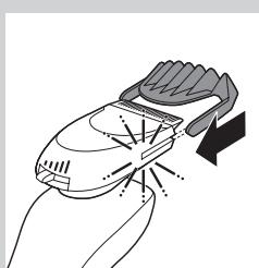
**1** Nasuňte hřeben do vodicích drážek po obou stranách nástavce na zastřihování vousů (ozve se „klapnutí“).
