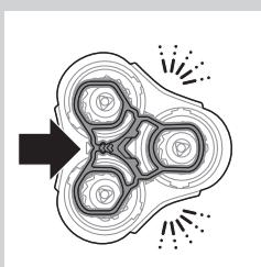
**9** Glisați înapoi sita de protecție (se fixează cu un 'click').
