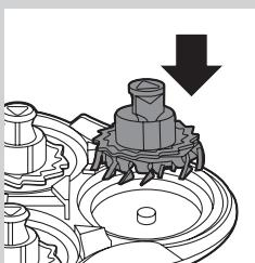
**7** Po vyčištění vložte střihací jednotku zpět do krytu pro holení tak, aby výstupky střihací jednotky směřovaly dolů.
