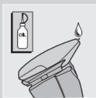
**2** 如果经常使用修发器，应每六个月用一滴缝纫机油润滑修发器机齿。
