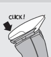
**4** 将修发器装到剃须刀上（将会听到喀哒一声）。现在可以使用修发器了。
