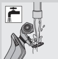
**2** Løsne ett og ett av de tre skjærehodene.
