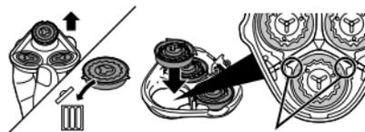
刃は3つとも○印の位置に外刃の突起部がくるようにセットしてください。
