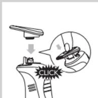
**2** Düzeltiliciyi, doldurma ve şarj standındaki düzeltici saklama yuvasından çekip çıkarın ve tıraş makinesine takın ('klik').
