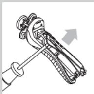
**3** Retirez la plaque arrière du logement de batterie à l'aide d'un tournevis.
