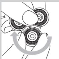
*Remarque : Ne retirez qu'une seule tête de rasage à la fois. Vous éviterez ainsi de remonter une tête de rasage sur un support inapproprié, ce qui est important car deux têtes de rasage ont des orifices spéciaux de distribution pour lotion de rasage. De cette façon, vous ne pourrez pas non plus intervenir les lames et les grilles de différentes têtes de rasage, ce qui pourrait affecter les performances de l'appareil.*
