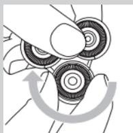
*Nota: rimuovete solo una testina di rasatura alla volta, in modo che possiate rimontare la testina sul supporto originale, operazione importante per le testine con speciali fori per l'erogatore. In questo modo, eviterete anche di mischiare le lame e i dispositivi di protezione delle diverse testine e preservare le prestazioni di rasatura.*
