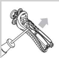
**3** Entfernen Sie das rückwärtige Gehäuse mit einem Schraubendreher.
