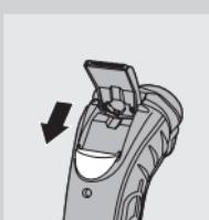
**1 Abra el cortapatillas deslizando el botón hacia abajo.**
