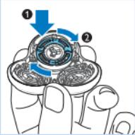
注意：重新插入電鬍刀刀頭與重新裝上固定環時，請以手持握電鬍刀刀頭。進行這些動作時，請勿將電鬍刀刀頭固定座放置在某種表面上，否則可能造成損壞。
