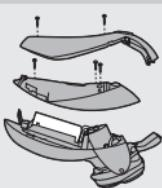
**2** 让剃须刀运转直到停止，拧下螺钉并打开剃须刀。
