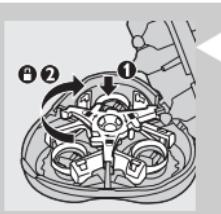
**5** 将固定架放回剃须部件 (1)，并沿顺时针方向转动锁 (2)。
