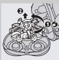
**1** 打開電鬍刀組，將鎖扣逆時針方向轉動
