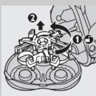
**1** 打开剃须部件，逆时针转动锁（1），将固定架取下（2）。
