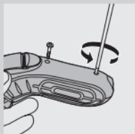
**3** 轉開電鬍刀背面的兩個螺絲，拆下握柄的背板。
