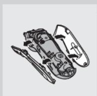
**4** 將側面的護板拔離密封的供電裝置。
