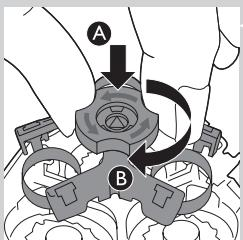
**7** Następnie załącz element zabezpieczający na moduł golący (A) i obróć blokadą (B) w prawo.
