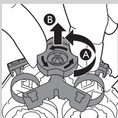
**4** Okrenite kvačicu za zaključavanje u smjeru suprotnom od smjera kazaljke na satu (A) i izvadite okvir za pričvršćivanje (B).
