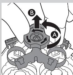
**4** Поверните фиксатор против часовой стрелки (A) и снимите крепежную рамку (B).
