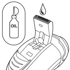
**Sugestie:** Pentru a garanta performante optime de tundere, ungeti dinții dispozitivului de tundere cu puțin ulei pentru mașina de cusut o dată la șase luni.
