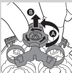
5 Поверните фиксатор против часовой стрелки (A) и снимите крепежную рамку (B).
