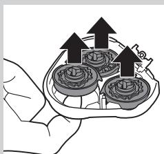
**5** Holicí hlavy čistěte vždy po jedné. Každá holicí hlava se skládá z nožového věnce a holicí korunky.
