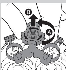
**5** Odkręć blokadę w lewo (A) i wyjmij element zabezpieczający (B).
