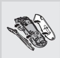
**3** Ôtez les deux vis à l'arrière de l'appareil et retirez le panneau arrière du boîtier.
