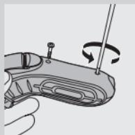
**2** Lassen Sie den Motor des Rasierers laufen, bis er stillsteht. Lösen Sie dann die beiden Schrauben in der Haarauffangkammer.
