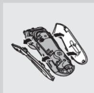
**3** Lösen Sie die beiden Schrauben hinten am Rasierer und nehmen Sie die Verkleidung an der Rückseite ab.
