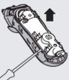
**6** Retirez le panneau arrière du bloc d'alimentation à l'aide d'un tournevis.
