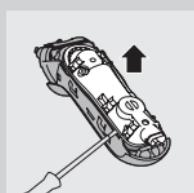
**5** Lösen Sie die drei Schrauben in der versiegelten Elektronikeinheit.
