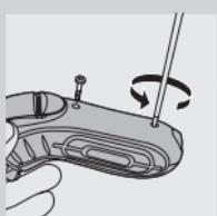
**2** Laissez le rasoir fonctionner jusqu'à l'arrêt complet du moteur, puis retirez les deux vis du compartiment à poils.
