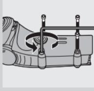
**2** 讓電鬍刀持續運轉直到完全停止，使用螺絲起子轉開鬍渣室上的兩個螺絲，並拆除鬍渣室。
