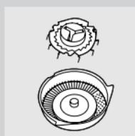
**1 打開電鬍刀組，以逆時針方向轉動鎖扣(1)，並拆下固定架(2)。**
