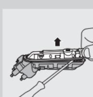
**6** 在電鬍刀背面使用螺絲起子轉開供電裝置上的三個螺絲。
