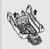
**3** 使用六角起子轉開電鬍刀正面的四個螺絲，並拆下握柄正面的護版。
