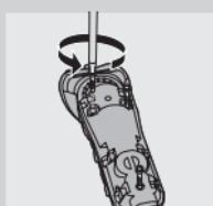
**4** 將側面的護板拔離密封的供電裝置。
