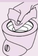
Khi bạn dùng máy lần đầu tiên sau khi tẩy sạch cặn bám, không được để mặt trên khuôn chụp mặt ngay khi hơi nước bắt đầu bốc lên. Có thể vẫn có một chút giấm hoặc chất tẩy cặn bám còn trong hơi nước đầu tiên bay ra từ máy.
