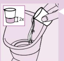
**3** Cho nước vào máy bằng nước ở vòi, dùng cốc đong.
