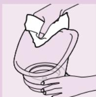
**4** ถอดหน้ากากอบไอน้ำออกจากฐานเครื่อง ใช้ผ้าชุบน้ำหมาดๆ เช็ดทำความสะอาดหน้ากาก จากนั้นเช็ดให้แห้ง
