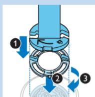
**6** 將固定環座放置於固定環上 (1)，將其放在電鬍刀刀頭上 (2) 並以順時針方向轉動 (3)，以重新裝回固定環。
