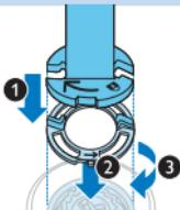
**7 將固定環座放置於固定環上 (1)，將其放在電鬍刀刀頭上 (2) 並以順時針方向轉動 (3)，以重新裝回固定環。**
