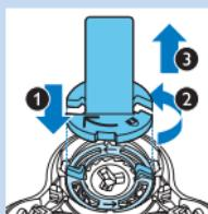
**3** 將固定環座放置於固定環上 (1)，向逆時鐘方向旋轉 (2)，然後將其自電鬍刀刀頭拿取 (3)。
