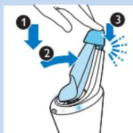
5 將電鬍刀置於固定座中 (1)，將電鬍刀向後傾斜 (2)，然後按下頂蓋以連接電鬍刀 (會聽見「喀噠」一聲) (3)。
