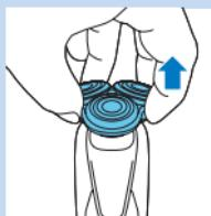
**2** 將電鬍刀刀頭固定座從電鬍刀組底部抽出。
