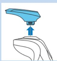
**2** 將鬚角刀配件的突耳插入電鬍刀頂端的凹槽，再將鬚角刀配件往下壓，即可安裝到本產品上(會聽見「喀噠」一聲)。
