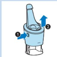
**2** 將空的清潔補充匣從 SmartClean 智慧型清洗系統中拿出，將補充匣中剩餘的清潔液倒空。
